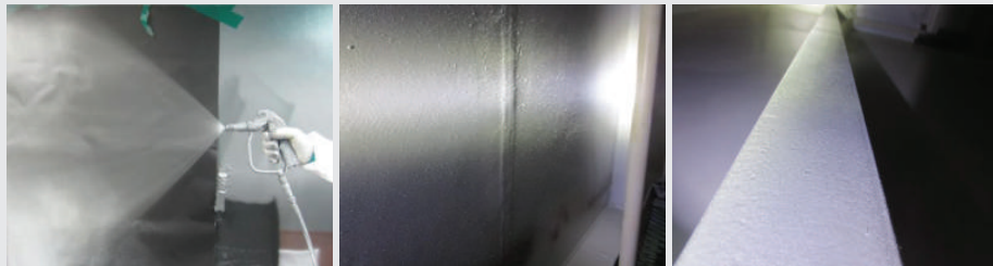
喷涂性差（见上图）会导致周边区域出现漆雾，并降低表面的光泽度。
