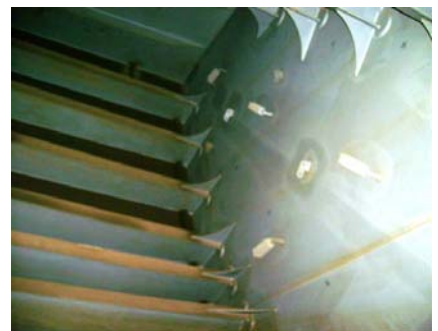
159,000DWT原油轮营运5年后, 压载水舱极佳的整体性能
