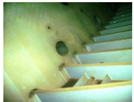
159,000DWT原油轮营运5年后, 压载水舱的防腐保护状况极佳
