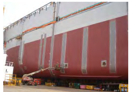
新造船时施工用于水下船体的分段拼缝
