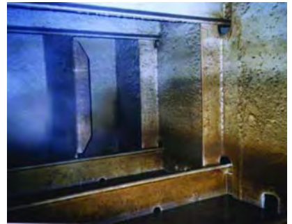
15个月后压载水舱内的绝佳状态
