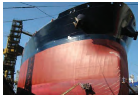
高压淡水冲洗后的坞内状态
