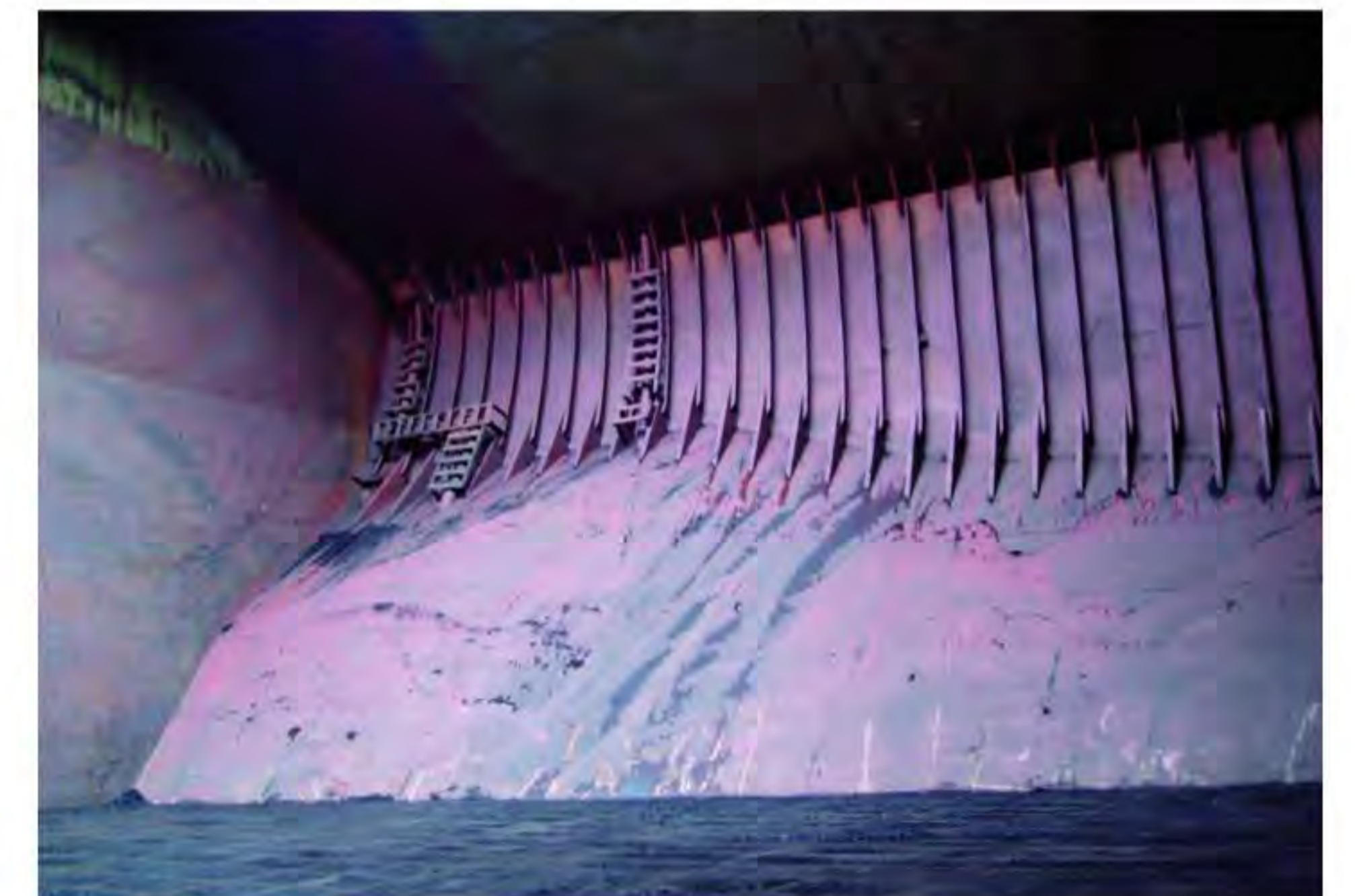
营运3年后，主要装运煤（粘在舱壁上的货物极少）
