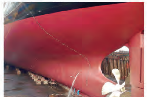
过喷少，减少坞内清理和施工人员所面临的曝露危险
