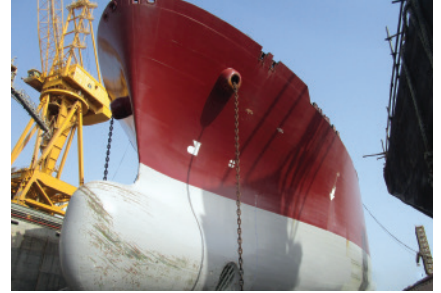
30개월간 운항한 LNG tanker. 미세한 슬라임만 발생.
