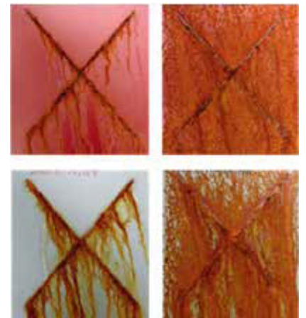
競合他社製品との比較 塩水噴霧試験において1000時間後の状態
