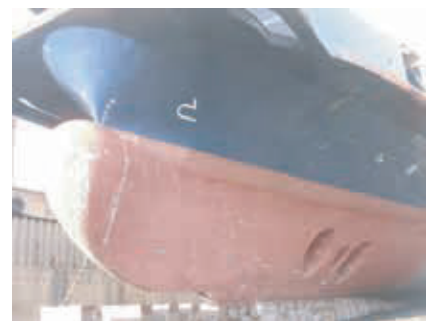
5,812DWT RORO船にて 塗装後12ヶ月、UK—フランス航路
