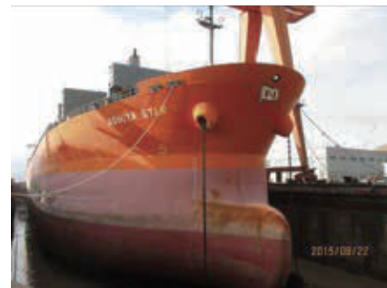
52,223DWT バルクキャリアにて 塗装後21ヶ月、中国—南米航路
