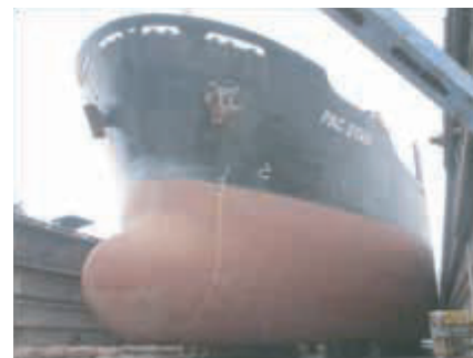
28,225DWT バルクキャリアにて 塗装後8ヶ月、東南アジア—豪州航路
