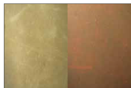
Intersleek. Biocidal SPC コンテナ船、塗装後37ヶ月、防汚剤入りSPCとの比較
