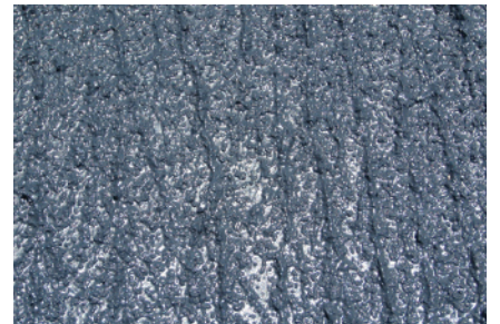
전투기, 차량 및 선원들이 이동 시 적합한 미끄럼 방지 표면
